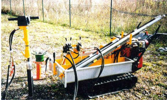
**Mobile Ausrüstung:** Schlaghammer mit E-Motor Makita HM 1400 und 1800, Einschlagarbeit 33,7 und 55,3 J. Hydraulisches-Stangenziehgerät S 2005, Hubkraft 140 kN, Hydraulikanlage von Nordmeyer, 500kN Hubkraft.
