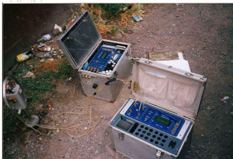
**Bodenluftprobenahmesystem BLSP 201** von Meta, Messkoffer einschließlich verlängerbarer Sonden.
